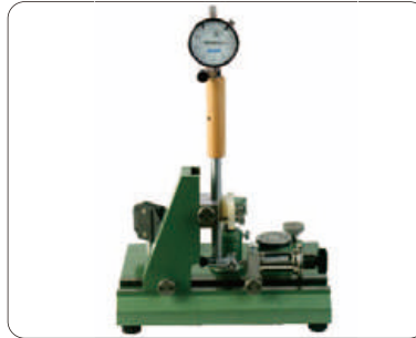
Silindir komparatörü için hassasiyet kontrolü (Aralık 6-450mm)
