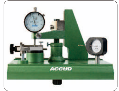
Komparatör saatlerinin yanıl kuvvet kontrolü
