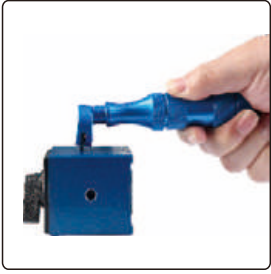
Adım 1: Yüzeyde izgara kesimi
