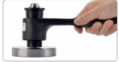
Test kuvvetini uygulamak için çekiç darbesi
